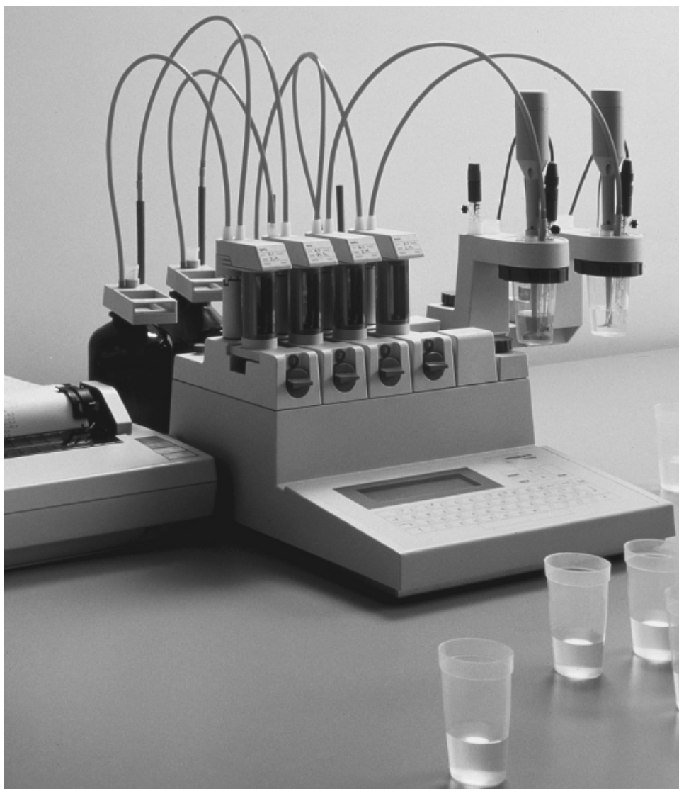
Hình 37: Ví dụ về một thiết bị chuẩn độ tự động sử dụng trong các phòng phân tích
